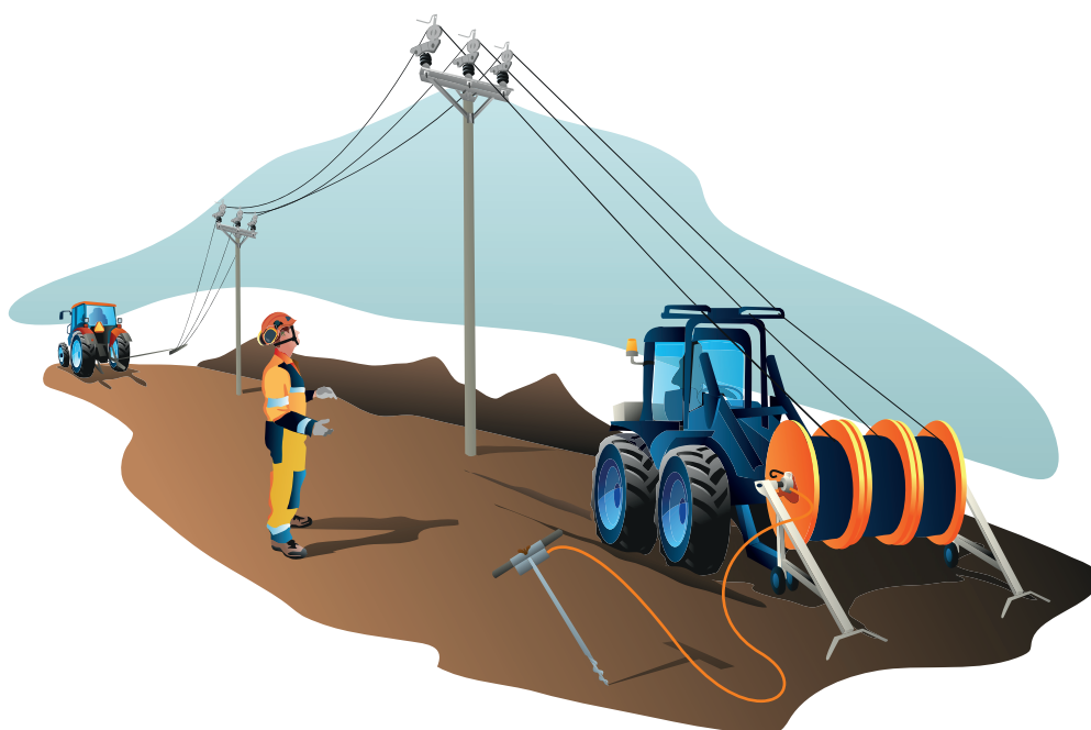
Bild 19. Exempel på potentialutjämning mot jord vid lindragning.
