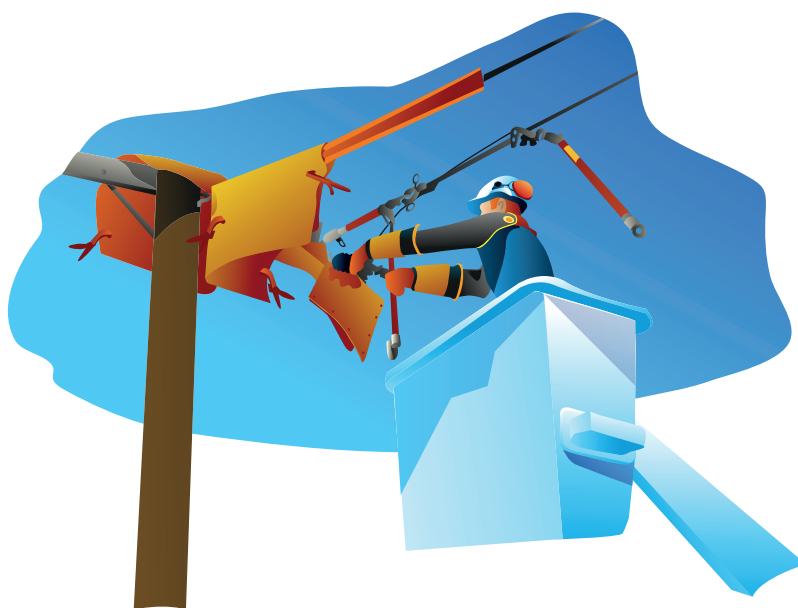
Bild 36. Arbete med isolerhandskmetoden enligt arbetsmetoden Arbete med spänning.
