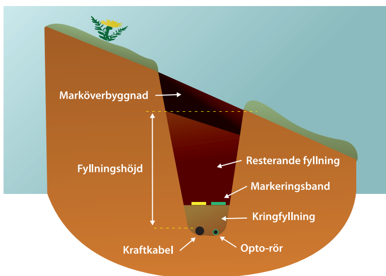
Bild 14. Fyllningshöjd i släntmark.
