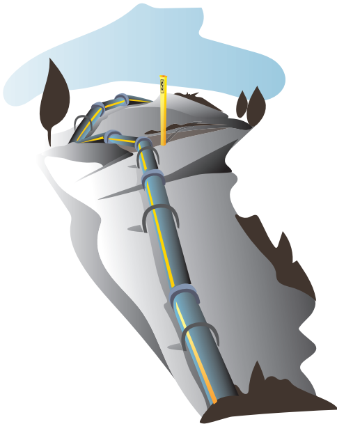
Bild 33. Kabelrör med förankring ovan mark.
