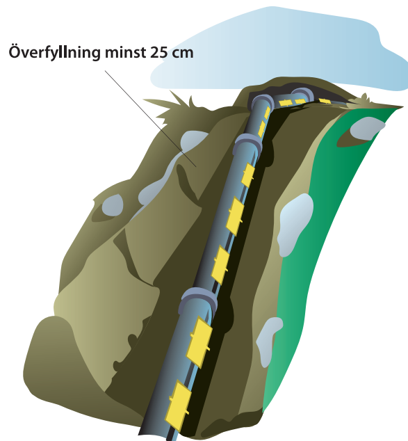
Bild 32. Bilden redovisar grund kabelförläggning före återfyllning.
