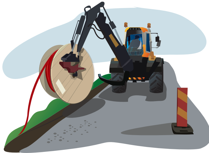
Bild 27. Schakt och kabeldragning med traktorgrävare.
